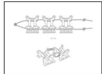
Mehrere Module können mittels Gliedern, Verbindungselementen oder Reepschnüren aneinandergereiht werden, um sich den unterschiedlichen Einsatzbedingungen anzupassen.
